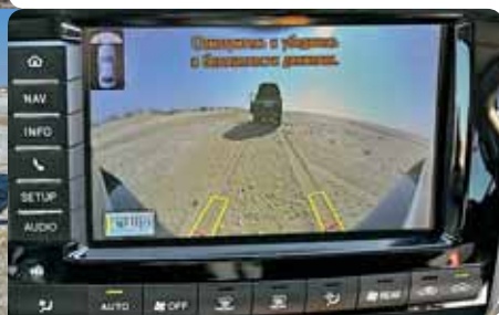
▲ На 8-дюймовый сенсорный экран выводятся картинки с четырех камер бокового обзора – как отдельно, так и вместе. Объективы направлены к земле, что помогает увидеть рядом с машиной, скажем, острый камень.
